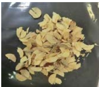
材片採取： φ15mmのドリルで採取
