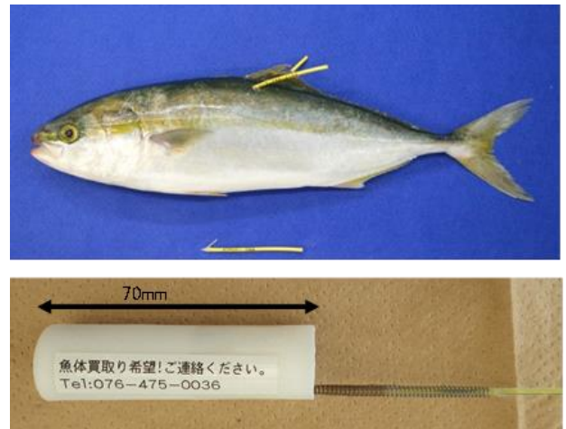
図2 ダートタグを装着したブリ(上)および2018年に使用したアーカイバルタグ BLS-Type2DTT-17L(下)
