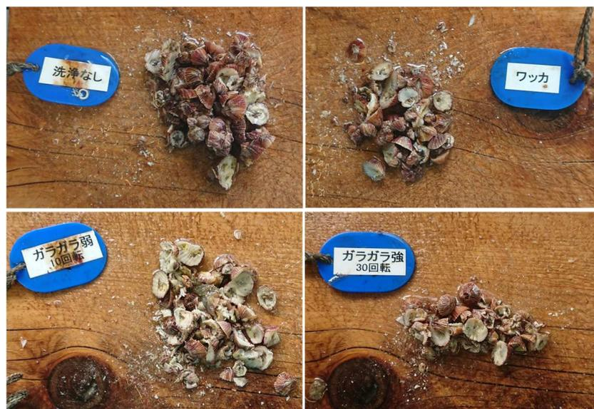
図7. 試験終了時の付着物の量（上段左から、除去なし区、提灯網区、下段左からガラガラ弱区、ガラガラ強区）
