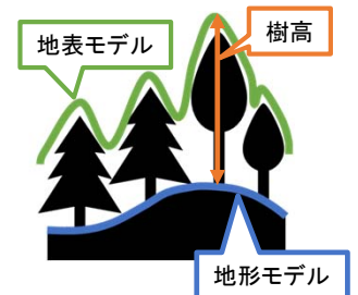
UAVレーザ計測による樹高計算の概念図
