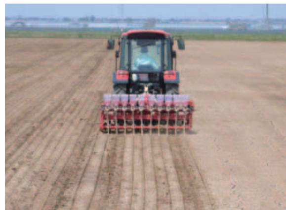
不耕起V溝播種機にてV溝をつくり、種をまいている様子
