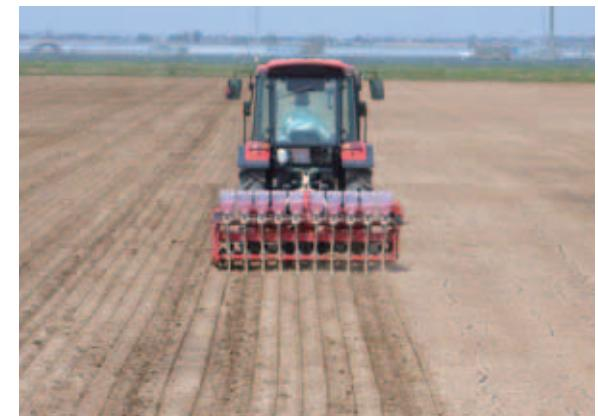
不耕起V溝播種機にてV溝をつくり、種をまいている様子
