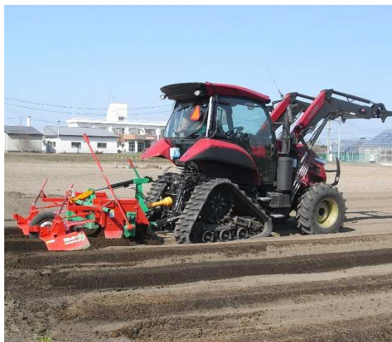
自動操舵トラクタでのトレンチャー耕 (4月27日撮影)
