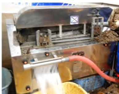
図 1. クマタニ式貝殻表面洗浄機械
