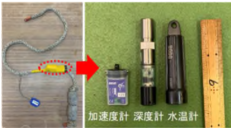
図 2. 養殖施設の幹綱に設置した観測機器 (メモリー式加速度計については丸籠最下段にも設置)
