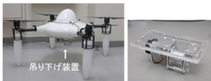
図3. 「吊り下げ装置」をドローン機体下部に装着した状態(左)とウインチ部(右)
