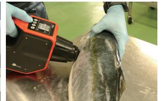
脂質の非破壊計測試験
