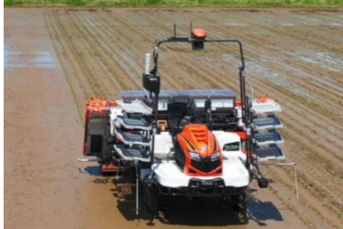
無人自動操舵ロボット田植機
