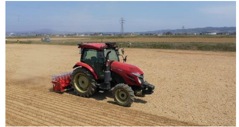
ロボットトラクタによる播種の様子 (運転席は無人です)
