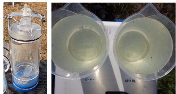
図3 試作採水器と採水した表層水の湖水サンプル（左：ビーカー、右：試作採水器）
