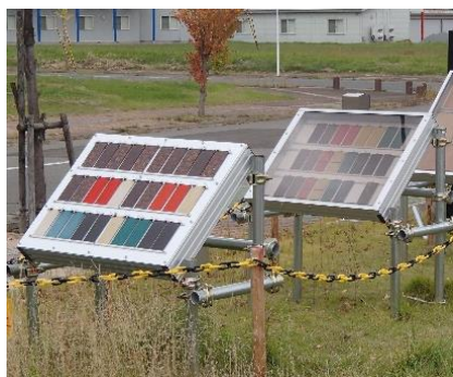
写真 1. 屋外暴露試験器
