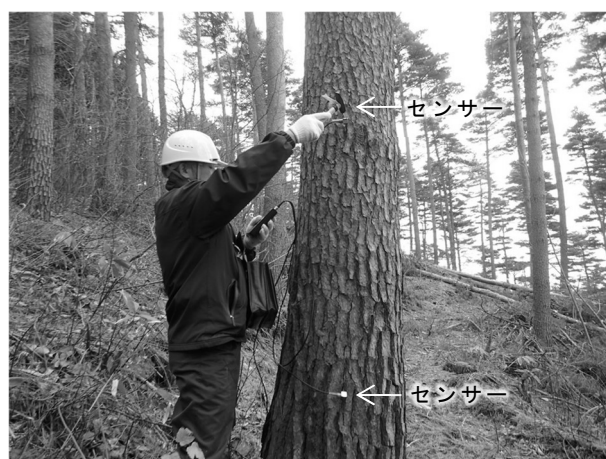
図-1 立木の応力波伝播速度測定
