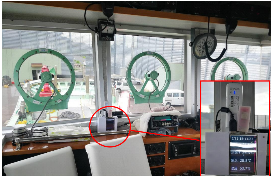
写真6 運転席に設置した中継機の設置状況
