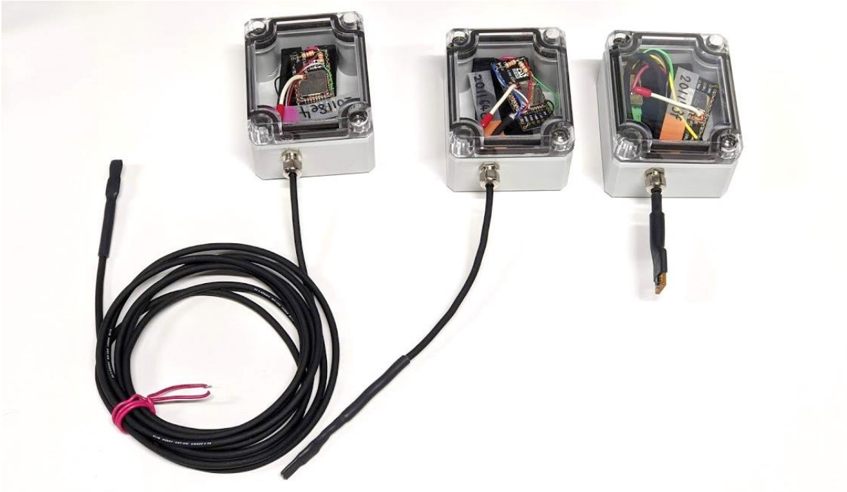
写真2 水温センサ（左、中央）と船上温湿度センサ（右）
