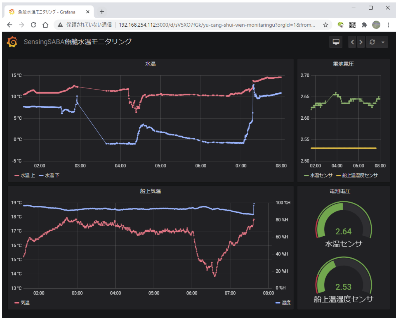
図6 Grafanaによる魚船水温および船上温湿度結果の可視化
