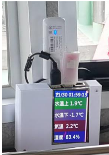
写真3 魚艙水温・船上温湿度センサデータのネット中継機
