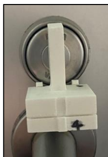
図 3 施錠監視デバイス
