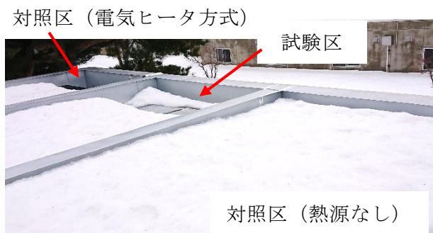
図 2 屋外試験用の実証試験棟と融雪状況
