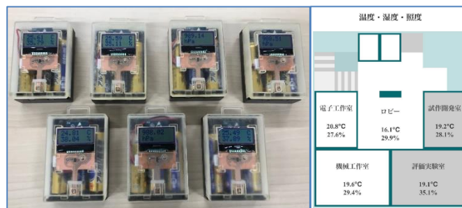
図2 温湿度測定デバイスと IoT 開発支援棟見える化システム
