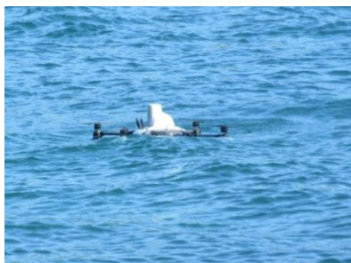
図1 着水型ドローン
