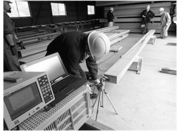
図－2 縦振動法による動的ヤング係数の測定状況
