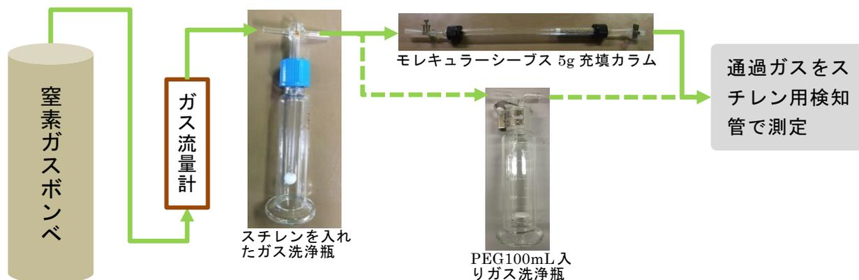
図2 除去材の高濃度ガス状スチレンに対する除去・低減能の評価系
