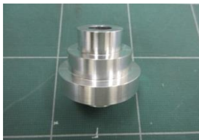
図1 アルミ製段差形状試験片
