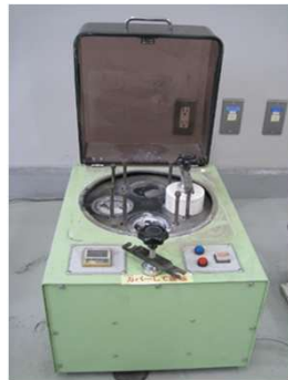
【ミニカップミル】 定量分析する場合は粉 体化して試料を均一化 する
