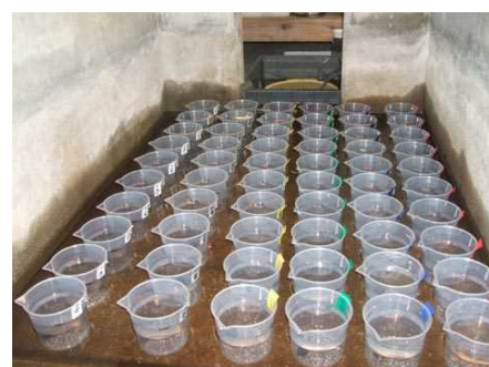
図 2. 湧水かけ流し水槽を使った塩分耐性試験
