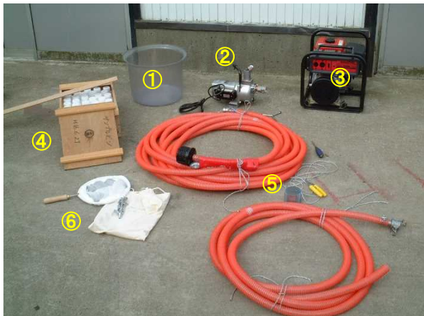
図 2. ヤマトシジミラーバ調査機材一式 ①20ℓパンライト水槽 ②エンジンポンプ ③発電機 ④サンプルビン ⑤ポンプの延長ホース ⑥プランク トンネット
