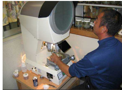
図 12. 万能投影機を使ったラーバの計数
