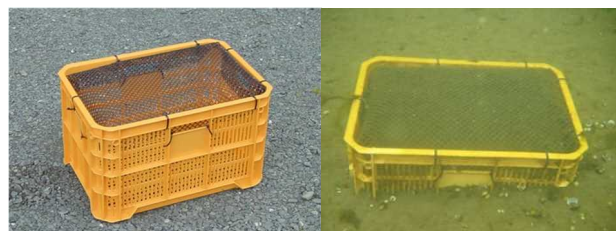
図4. 十三湖の成長試験に使用したカゴ(左)と設置状況
