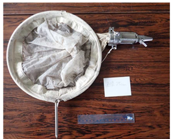
図 3. プランクトンネット（目合い 64 \mu m）
