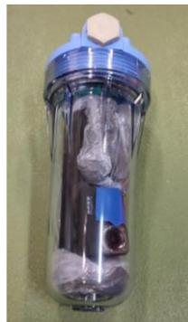
図1 動体検知用水中ハウジング
