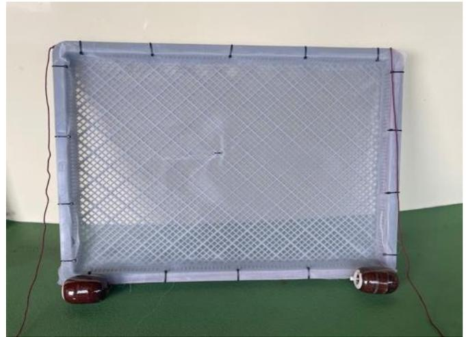
図 1. ふ化盆(枠 W64.5×D51.5×H33 cm 目合 560 $\mu$ m)
