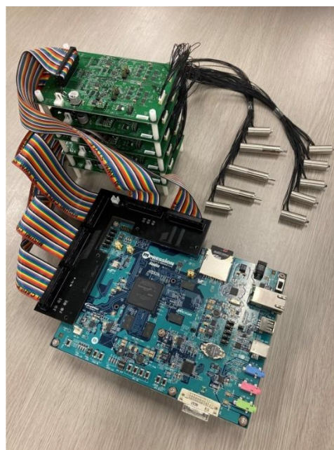
写真5 10軸対応モーションコントローラ試作機
