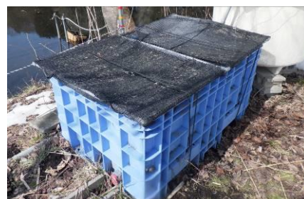
塩ビ管の骨組みにネットシートと遮光ネットを張って制作した蓋
