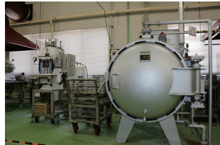
缶詰レトルト製造装置 (巻締機と高温高圧殺菌装置)
