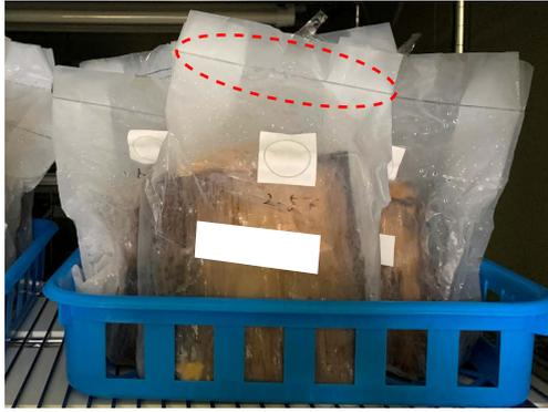
写真 -4 シーラーによる溶着
