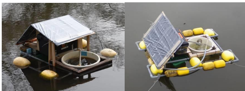
図1 製作した太陽光発電式かけ流し中間育成システム
