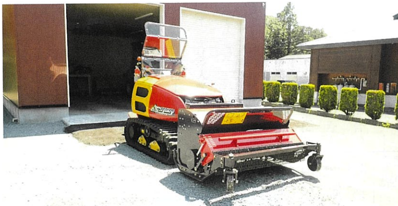
写真－1 多目的造林機械の全体写真（下刈アタッチメントを装着）
