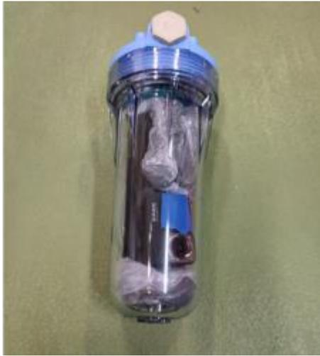
図 2. GoPro Labs を用いた汎用型水中ハウジング
