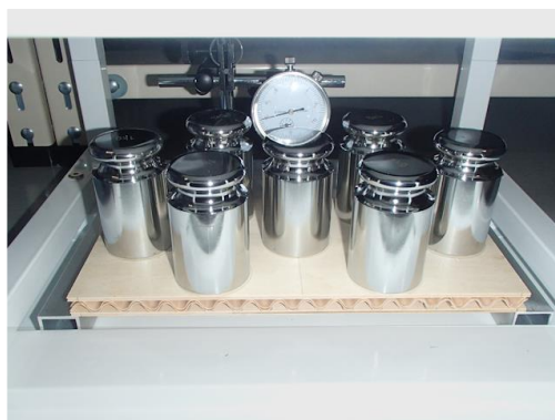
写真2 棚板のたわみ試験
