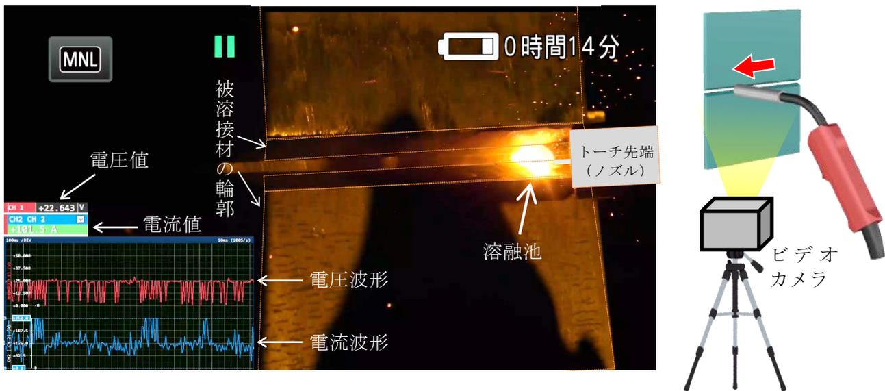
図10 ビデオカメラによる溶接部撮影映像（横向姿勢）
