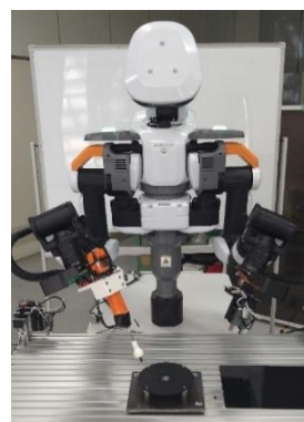
写真12 双腕型協働ロボット NEXTAGE によるボルト締め
