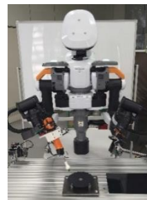
写真4 双腕型協働ロボットによる ボルト締め
