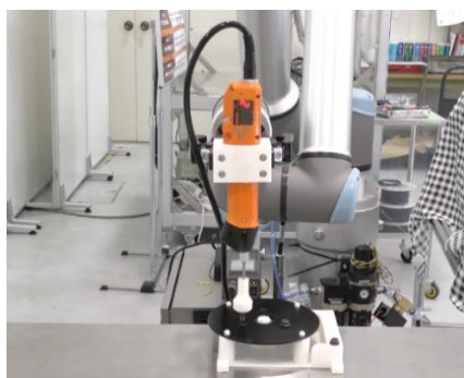
写真11 アーム型協働ロボット UR10e によるボルト締め
