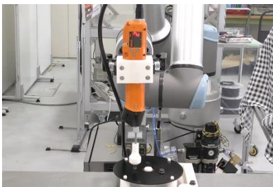
写真3 アーム型協働ロボットによる ボルト締め
