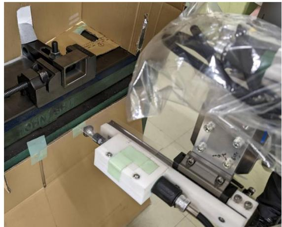
写真 実験用金属ブロックを使用したバリ取り実験の様子
