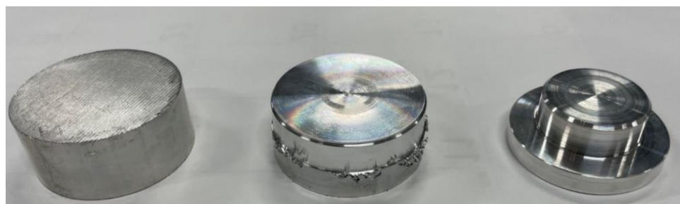
写真 3 加工工程 (左：母材、中央：表面加工後、右：裏面加工後)
