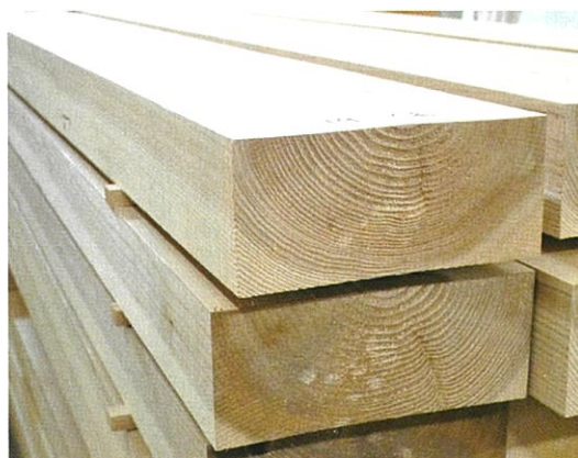
図10 大径材から製造した心去り平角材
