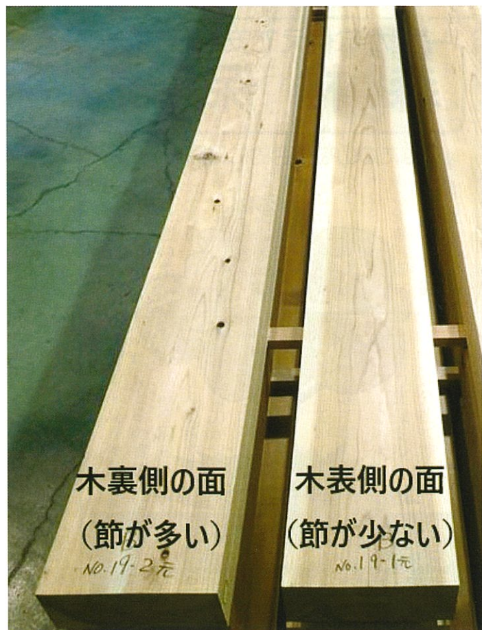
図8 心去り材の材面
