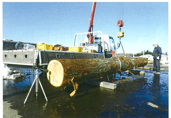
図4 丸太の縦振動ヤング係数の測定状況
