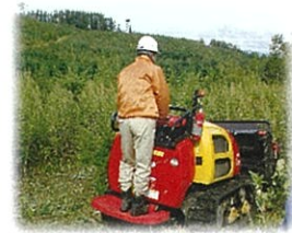
引用：キャニコム公式ページ https://www.canycom.jp/ 多目的造林機械「山もつとジョージ」 可能な作業：下刈り、伐根粉砕、残材集材、荷物運搬 特徴：乗用式(立ち乗り)、レバー操作、安全装置付き 下刈り作業経費：従来の半分
