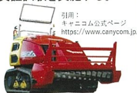
引用：キャニコム公式ページ https://www.canycom.jp/ 多目的造林機械「山もつとジョージ」 可能な作業：下刈り、伐根粉砕、残材集材、荷物運搬 特徴：乗用式(立ち乗り)、レバー操作、安全装置付き 下刈り作業経費：従来の半分
