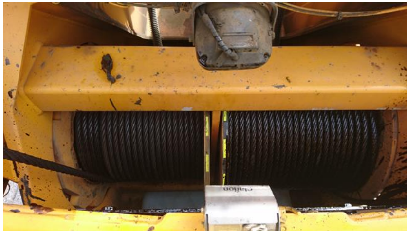
図1 クレーン車のウインチ部
