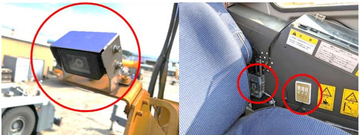
図 2 7 左：クレーン車に既設のカメラ 右：異常検知デバイスの搭載箇所
