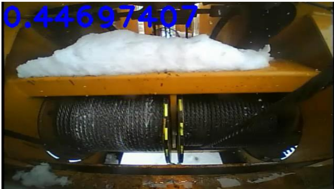
図 ウインチ部の映像と異常度のリアルタイム出力 (実稼働時は警告音を出力)
