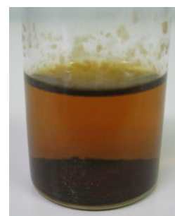
写真2．木酢液のホルムアルデヒドの低減に際して生じた沈殿物 (トリプトファン 12mM)
