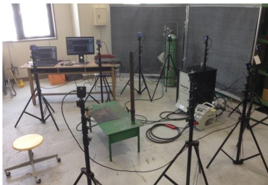
モーションキャプチャシステム (溶接作業計測時の配置例)
