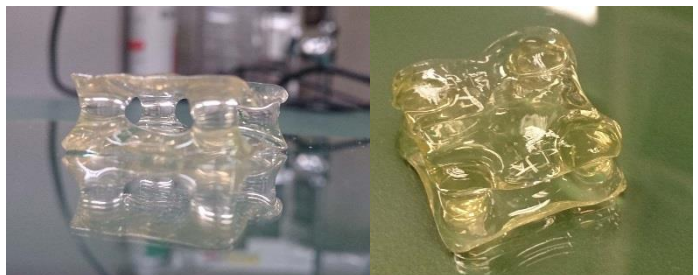
図 2 作製したゼラチンとアルギン酸からなるゲル構造物
