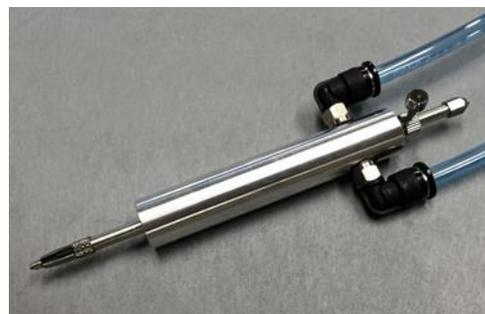
図 5 空圧打撃型インジェクタ
