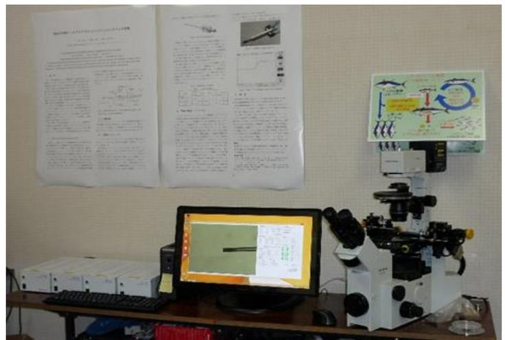
タッチパネル操作型マニピュレーションシステム
