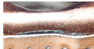
(a) 送り変更位置 0mm の工具摩耗
