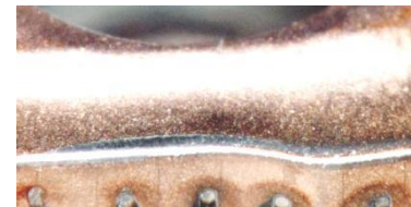
(b) 送り変更位置 3mm の工具摩耗
