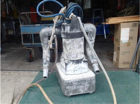
写真1 酸素溶解機(水中ポンプエアレーター)
