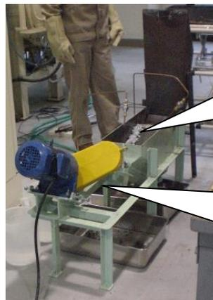
スラグ排出機構を備えたラボスケールのスラグ熱回収装置
