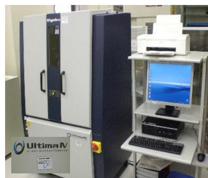
写真 X線回折装置
